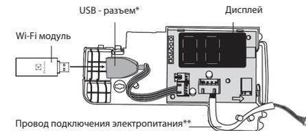
\* Разъем для подключения Wi-Fi модуля
