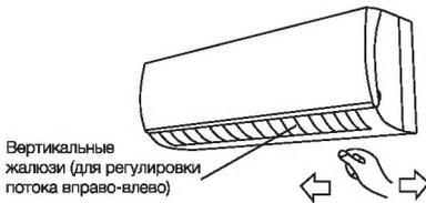
Направление воздушного потока в горизонтальной плоскости изменяется вручную поворотом вертикальных жалюзи.
